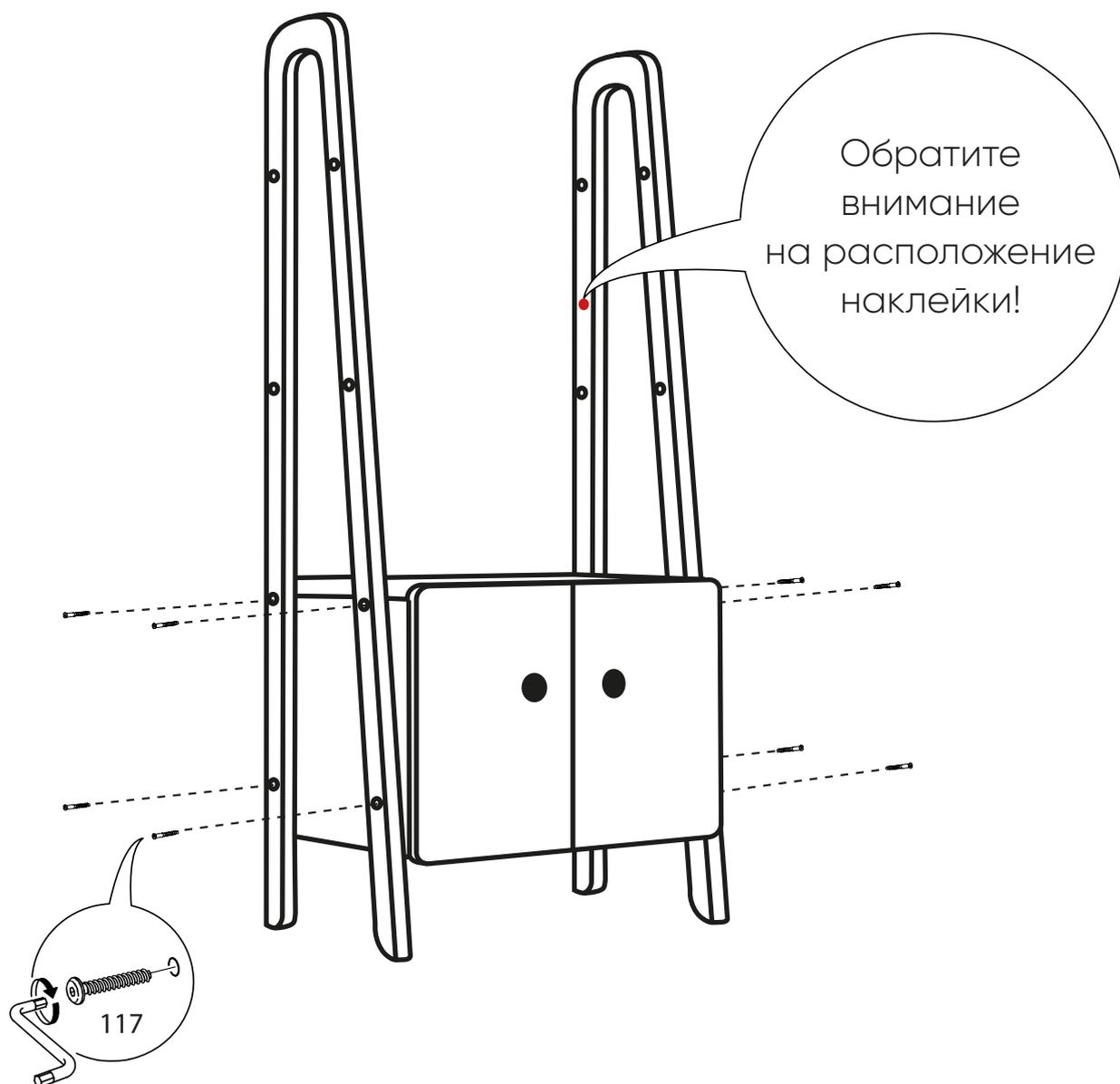
Установите нижнюю полку и соедините ее с ножками стеллажа, как указано на рисунке ниже. Затяните винты на 80%. Затем повторите действия со второй полкой. Затяните винты с усилием.
