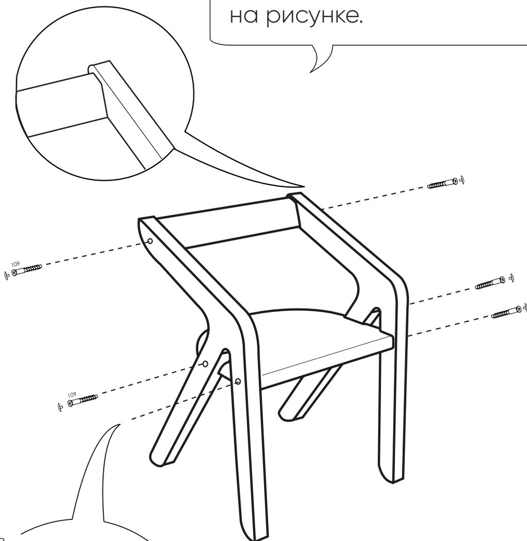
Установите стул на ровную поверхность так, чтобы все 4 ножки касались пола, после чего закрутите винты **#109** до конца. Установите на винты **#109** заглушки **#116**. Стул готов :)
