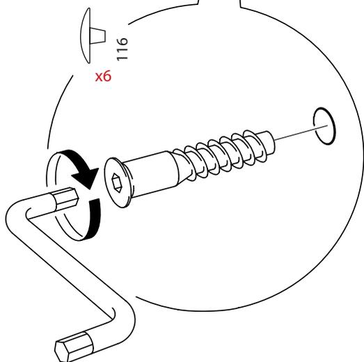
Установите стул на ровную поверхность так, чтобы все 4 ножки касались пола, после чего закрутите винты **#109** до конца. Установите на винты **#109** заглушки **#116**. Стул готов :)
